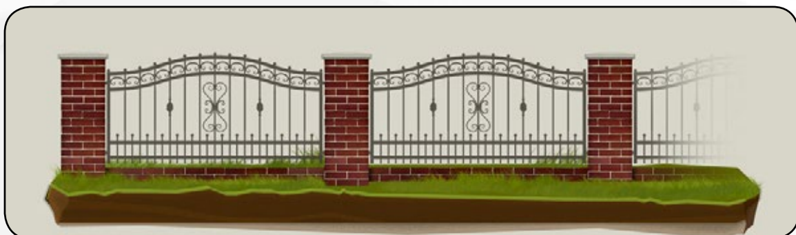
Zaunmontage auf einem verlinkerten Sockel, mit Klinkersäulen und Metallpfosten.
