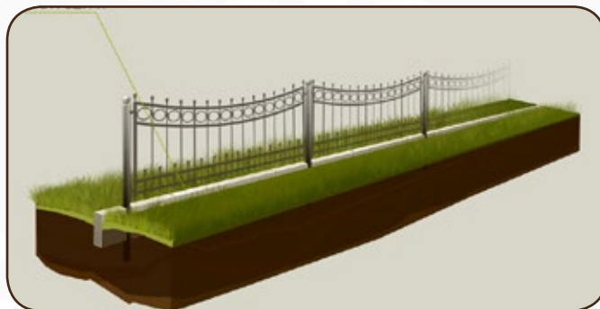
Verankerung in der Erde. Bordsteine werden zwischen den Pfosten gesetzt.
